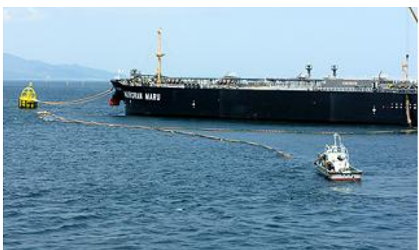
オイルフェンス展張作業
