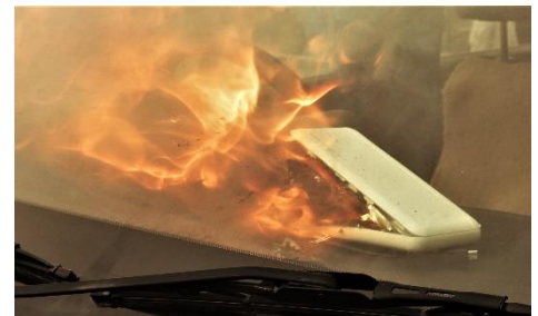
自動車内でモバイルバッテリーが発火する様子 （再現実験）
