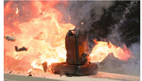
電動アシスト自転車用バッテリーが発火する様子 （再現イメージ画像）
