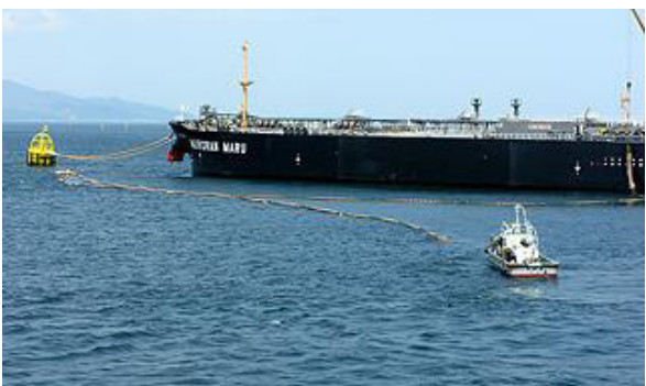
オイルフェンス展張作業
