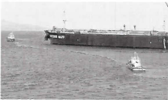
オイルフェンス展張作業
